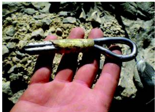
Ergebnis eines unsachgemäß gesetzten Hakens
